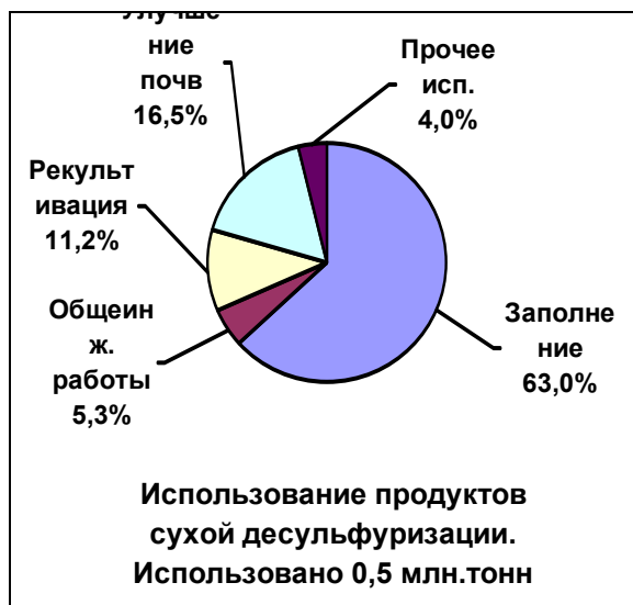
Рисунок 5. Обзор утилизации ПСУ в ЕС-15 в 1999 г. [90, ЕСОВА v. Berg, 1999].
